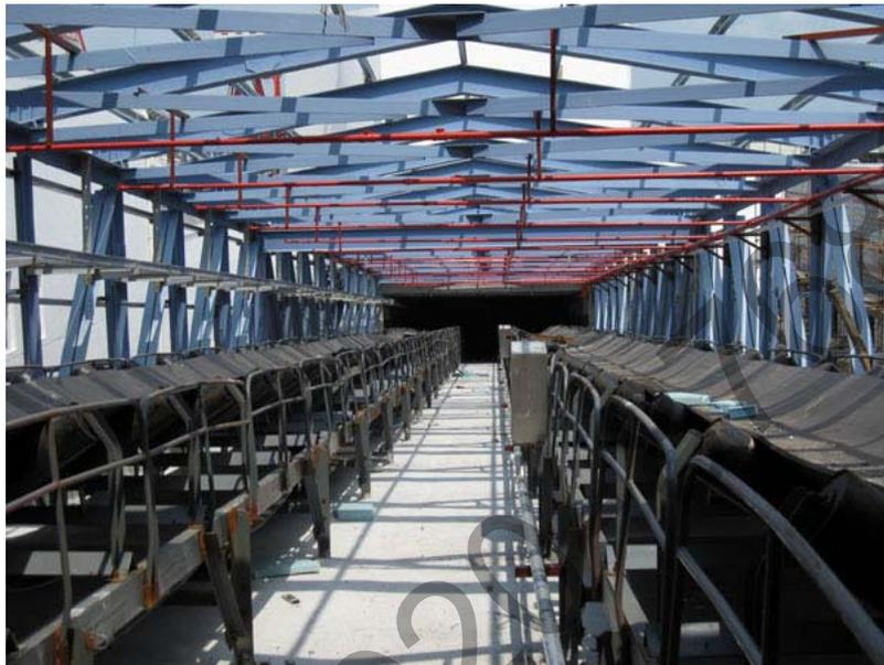
输煤系统承担着煤炭的输送、粉碎、储藏等任务，输煤系统的可靠运行是煤炭相关行业如煤炭矿井、燃煤发电厂、煤化工、冶金等正常、安全生产的前提。煤是易燃品，因皮带摩擦、煤粉自燃等原因很容易引发火灾。由于皮带是转动的，一旦发生火灾，火势会迅速蔓延，直至烧毁输煤皮带、烧断输煤栈桥以及烧坏输煤设备附近的其他设施，直接导致停产，所以它也是煤炭相关行业火灾监控的重点。
